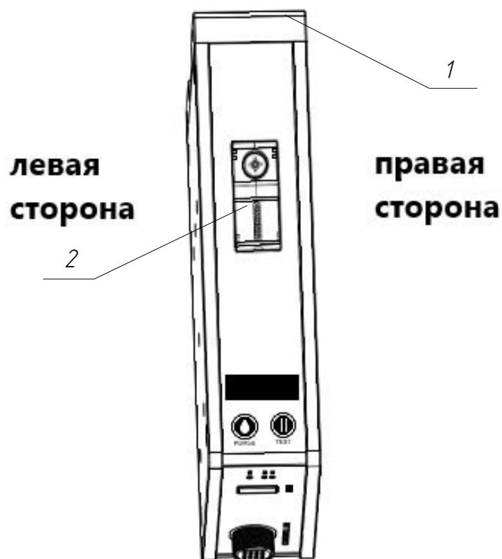
Рисунок 34. Ориентация печатающей головки. Условные обозначения: 1 — сопло; 2 — слот для картриджа.
